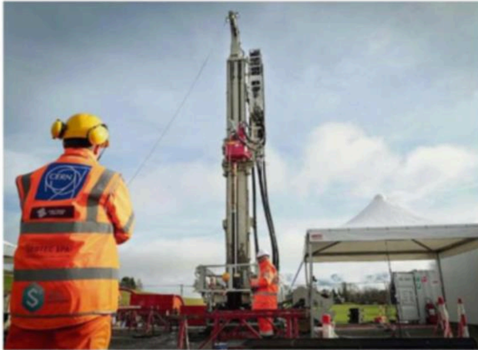
Un carottage près de La Roche-sur-Foron (P), en novembre, dans le cadre des études géologiques afin de déterminer le meilleur emplacement du futur collisionneur circulaire. De telles études de terrain doivent aussi se dérouler dans plusieurs communes genevoises. L'Agence SUD
